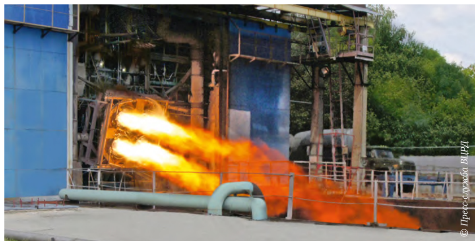
Огневые испытания двигателя в Воронежском центре ракетного двигателестроения
