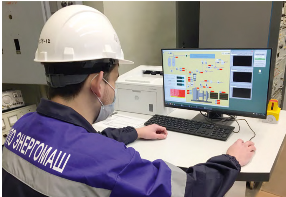
Пульт в виде мнемосхемы помогает оператору наблюдать за стендом и управлять испытанием
