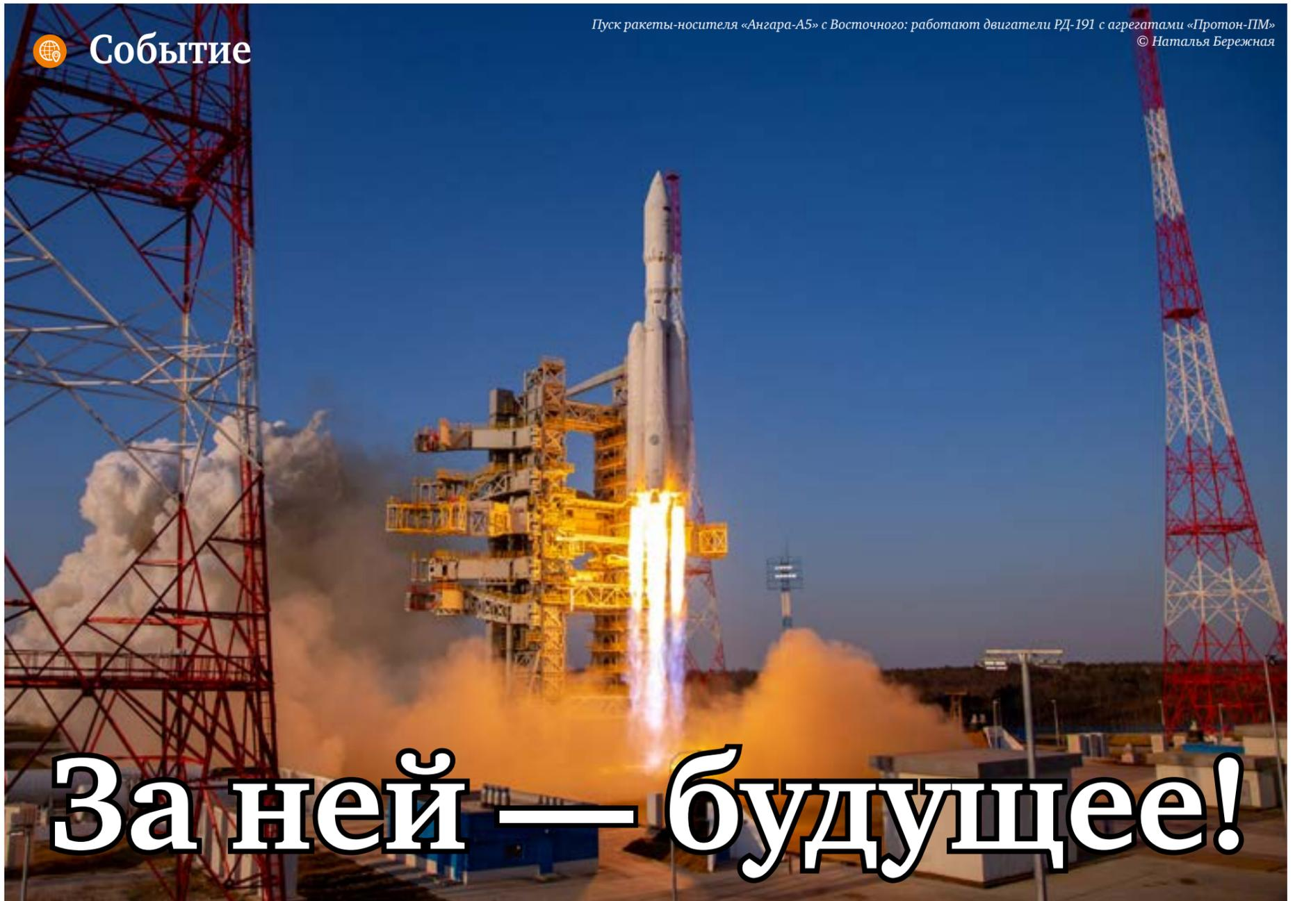
Пуск ракеты-носителя «Ангара-А5» с Восточного: работают двигатели РД-191 с агрегатами «Протон-ПМ»
